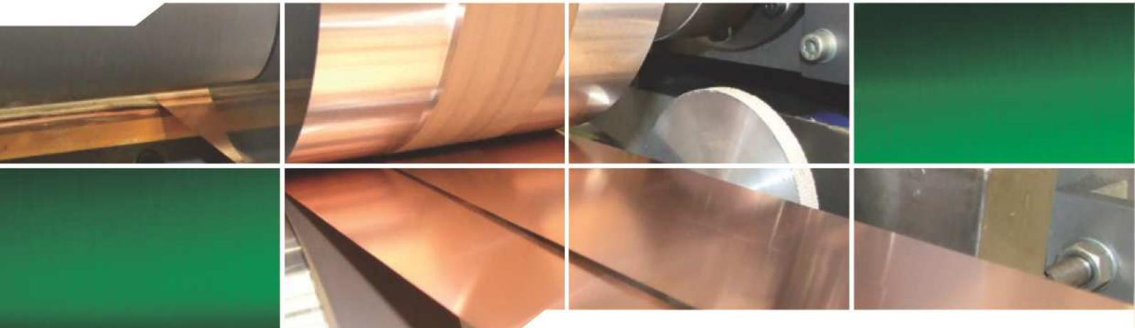
Schneiden und spulen von Präzisionsbändern großer Lauflängen auf unterschiedlichste Spulenkörper nach kundenspezifischen Anforderungen.
